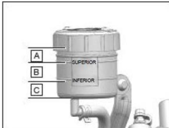
Depósito del líquido de frenos delantero
